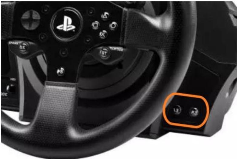
5) L3 ボタンと R3 ボタンを押しながら、T300 RS を PC の USB ポートに直接接続します。
